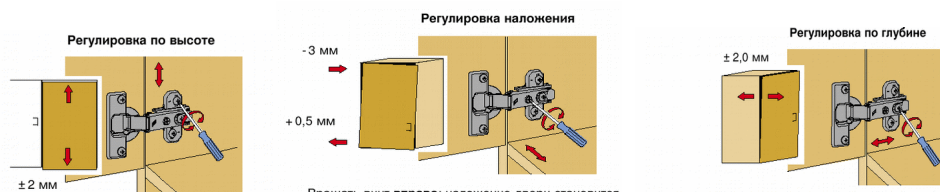
Рис.2 Схема установки и регулировки петель
